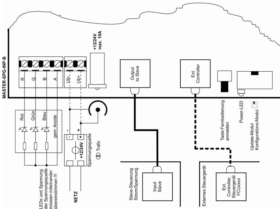
Abb. 1: Anschlussplan Master mit Fernbedienung
